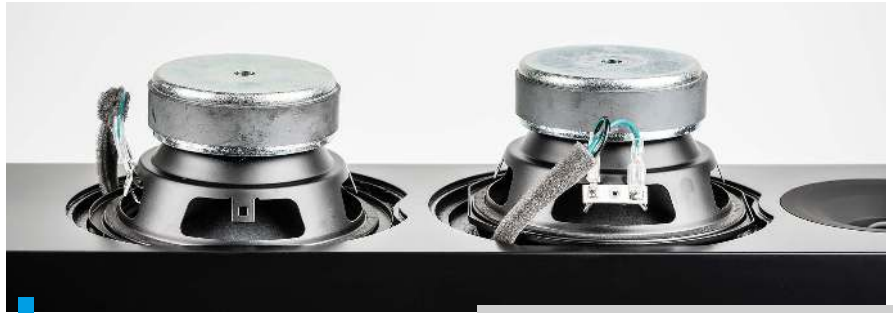
14-cm woofery mają standardowe blaszane kosze i średniej wielkości magnesy (90 mm).
